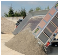
Zweiseitenkippfunktion für Schüttgut
