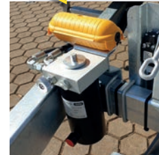
E-Hydraulik mit Notpumpe Pumpless für einfaches und bequemes Kippen mit dem Akkuschauber z.B. bei schwacher Batterie
