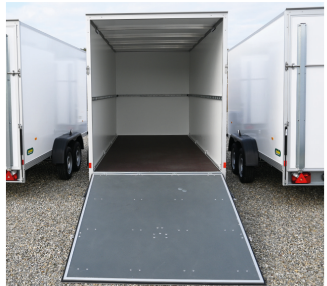
Auffahrklappe mit rutschhemmender Oberfläche
