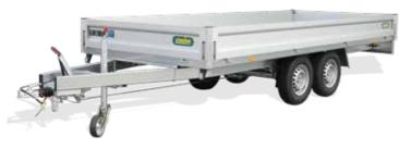
Tandem Pritschenhochlader zGG: 2600 kg • Nutzlast ca.: 2060 kg Innenmaße 4260 x 1750 x 300 mm Bereifung: 165 R13 Ladehöhe: ca. 690 mm
