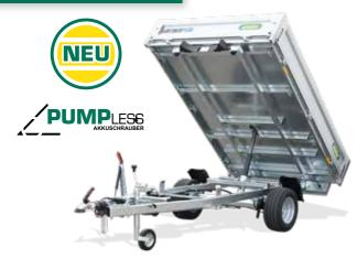
Einachs Heckkipper mit Pumpless Hydraulik zGG: 1300 kg • Nutzlast ca.: 985 kg Innenmaße 2300 x 1500 x 300 mm Bereifung: 195/55 R10 Ladehöhe: ca. 640 mm
