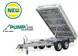
Tandem Heckkipper mit Pumpless Hydraulik zGG: 2600 kg • Nutzlast ca.: 2010 kg Innenmaße 2760 x 1500 x 300 mm Bereifung: 165 R13 Ladehöhe: ca. 735 mm
