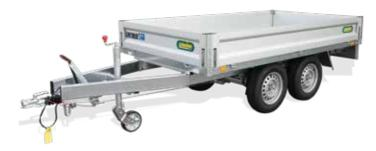
Tandem Pritschenhochlader zGG: 2000 kg • Nutzlast ca.: 1570 kg Innenmaße 2760 x 1500 x 300 mm Bereifung: 175/70 R13 Ladehöhe: ca. 690 mm
