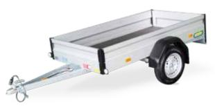
Kastenanhänger ungebremst Innenmaße 2100 x 1100 x 300 mm zGG: 750 kg • Nutzlast ca.: 630 kg Bereifung: 145/80 R13 Ladehöhe: ca. 500 mm
