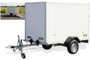
Einachs Plywood-Kofferanhänger mit Klappe zGG: 1300 kg • Nutzlast ca.: 930 kg Innenmaße 2550 x 1280 x 1530 mm Bereifung: 165 R13 Ladehöhe: ca. 550 mm
