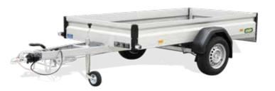
Kastenanhänger gebremst Innenmaße 2500 x 1260 x 300 mm zGG: 1300 kg • Nutzlast ca.: 1105 kg Bereifung: 155 R13C Ladehöhe: ca. 520 mm
