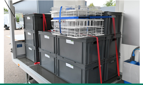
Ladungssicherungssystem inkl. Spanngurte für sicheres Verzurren der Ladung
