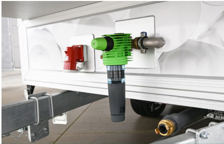
Frischwasseranschluss mit Druckminderer und Wasserfilter, Abwasseranschluss, 400 V-Eingangsstecker
