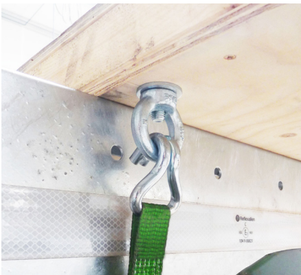
Zurröse für 350 daN Zurrkraft freigegeben
