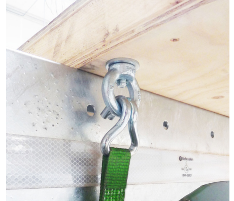
Zurröse für 350 daN Zurrkraft freigegeben
