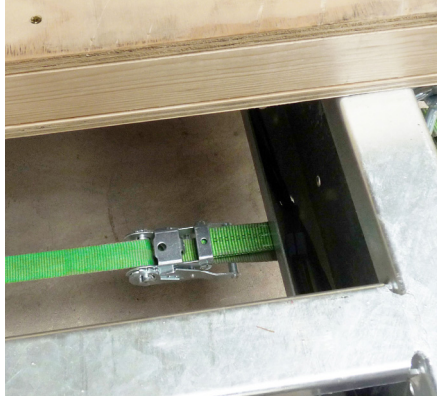
Bodenplatte mithilfe des Spanngurtes am Rahmen gesichert
