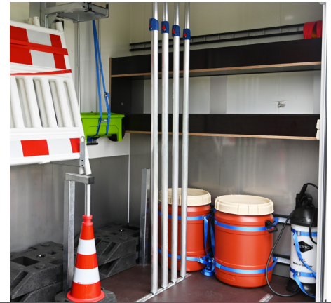
Sperrstangen und Airline-Schienen zur Ladungssicherung
