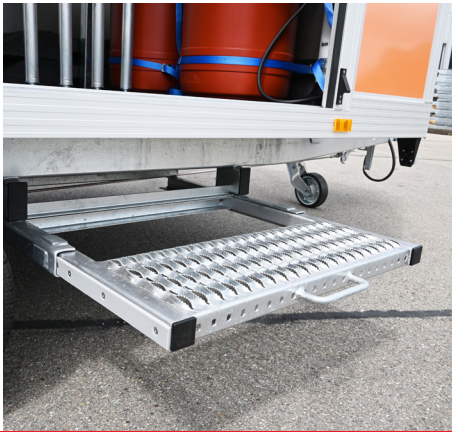
Robuste, ausziehbare Trittfläche
