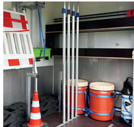
Sperrstangen und Airline-Schienen zur Ladungssicherung
