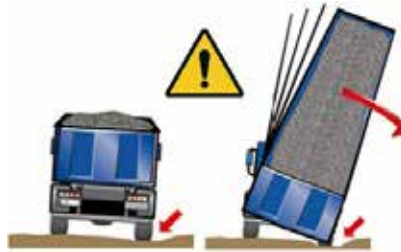
Abladen auf nachgebendem / unebenen Untergrund
