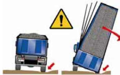
Abladen auf nachgebendem / unebenen Untergrund
