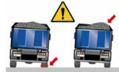
Ungleicher Reifendruck / Einseitige Verteilung der Ladung
