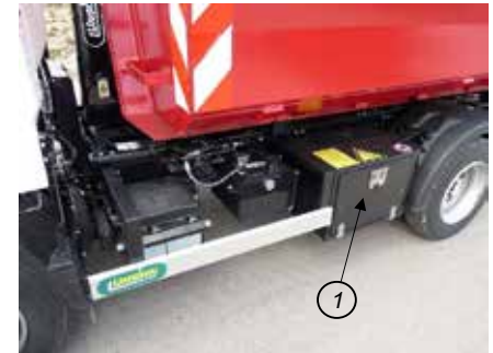
(1) Werkzeugkasten am Fahrgestell seitlich
