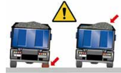
Ungleicher Reifendruck / Einseitige Verteilung der Ladung
