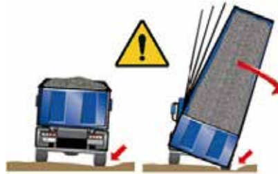
Abladen auf nachgebendem / unebenen Untergrund
