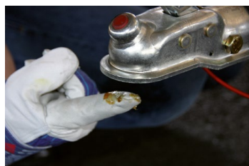
Bild: Kugelschale fetten
