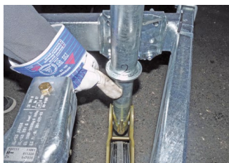
Bild: Stützrad ölen und fetten
