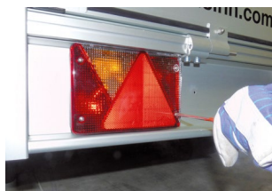
Bild: Rückleuchtenglas abschrauben
