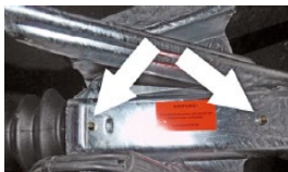
Bild: Schmiernippel Auflaufeinrichtung
