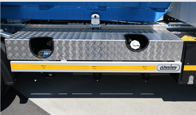
Schutzabdeckung über dem Tank
