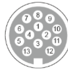
13-poliges System DIN / ISO 11446
