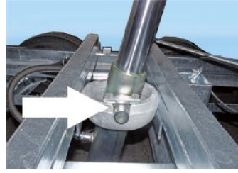
Bild: Kardanring schmieren
