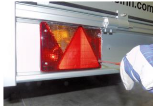
Bild: Rückleuchtenglas abschrauben
