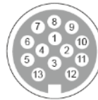
13-poliges System DIN / ISO 11446
