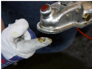
Bild: Kugelschale fetten
