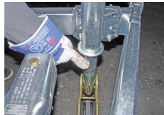
Bild: Stützrad ölen und fetten
