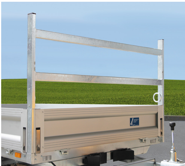
H-Gestell für flexiblere Transportmöglichkeiten
