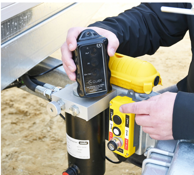
Funkfernbedienung zusätzlich zur Kabelfernbedienung
