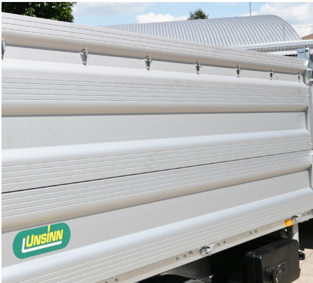
Bordwandaufsatz im UNSINN-Profil pendelnd gelagert
