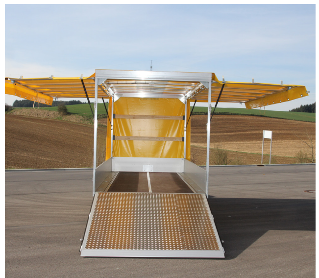
Hochlader Typ UH mit Planenaufbau und Auffahrklappe
