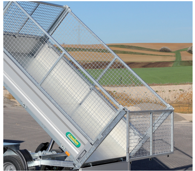
Gitteraufsatz mit integrierter Pendellagerung
