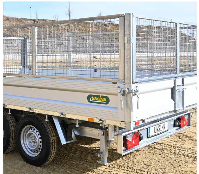
Gitteraufsatz mit integrierter Pendellagerung
