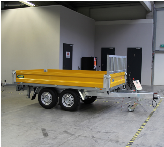
Pulverbeschichtete Bordwände Typ UH (RAL 1021)
