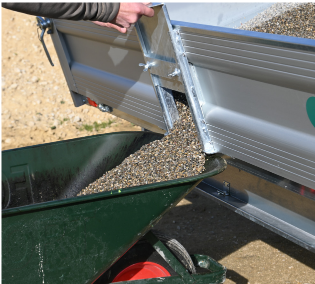
Kornschieber für dosiertes Abladen
